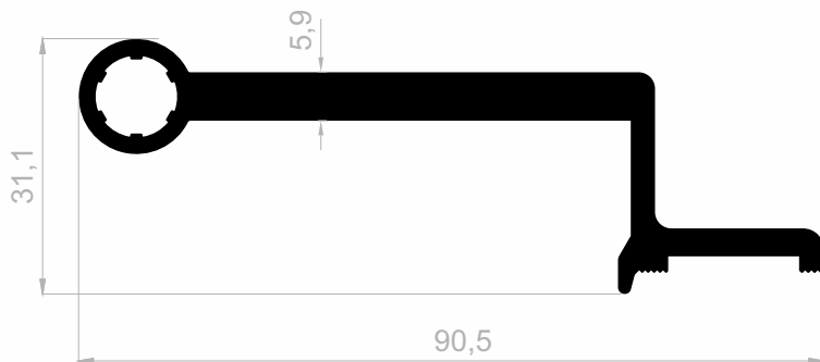
J 1621 SCHARNIERPROFILE GEWICHT : 1,499 kg/m
