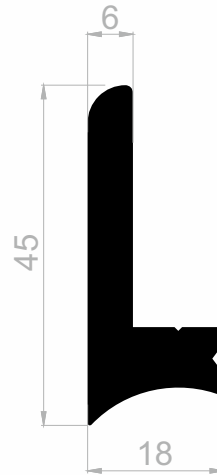
J 1267 GELÄNDER PROFILE GEWICHT : 0,925 kg/m
