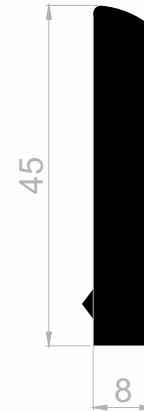
J 1089 GELÄNDER PROFILE GEWICHT : 0,908 kg/m
